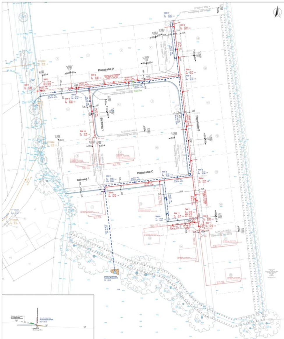
Abb.: geplante Entwässerung der öffentlichen Verkehrsflächen (Quelle: Wasser- und Verkehrskontor - Stand 02. November 2018)
