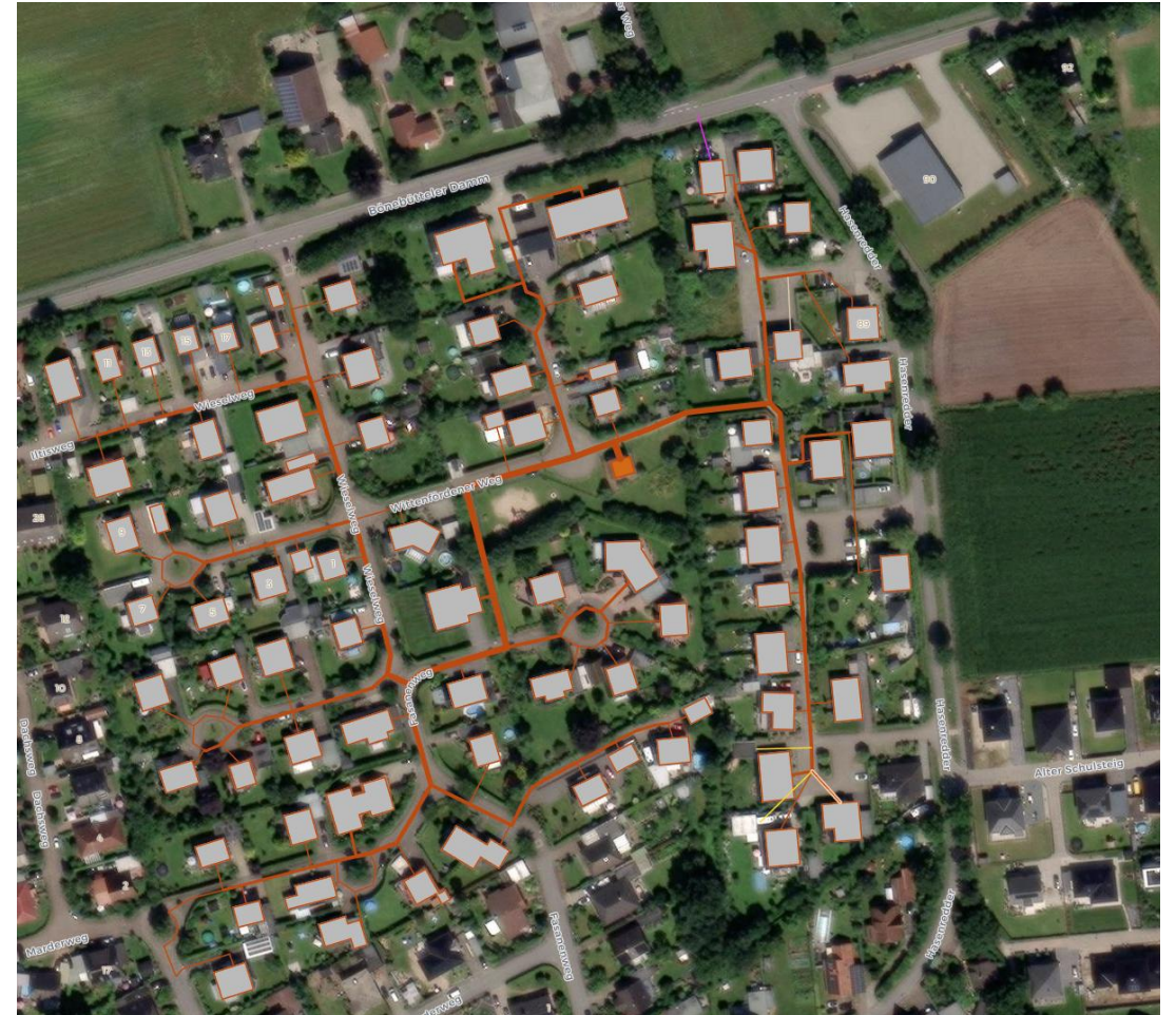
Abbildung des bestehenden Wärmenetzes in Bönebüttel Siedlung
