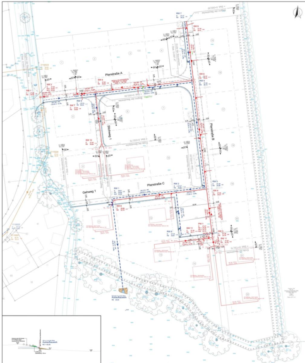
Abb.: geplante Entwässerung der öffentlichen Verkehrsflächen (Quelle: Wasser- und Verkehrskontor - Stand 02. November 2018)
